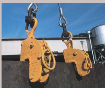
鋼板の堅吊り(2点角度吊り)
