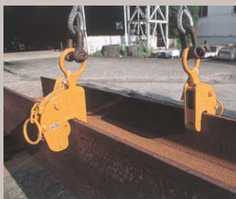
H型鋼の堅吊り(2点角度吊り)
